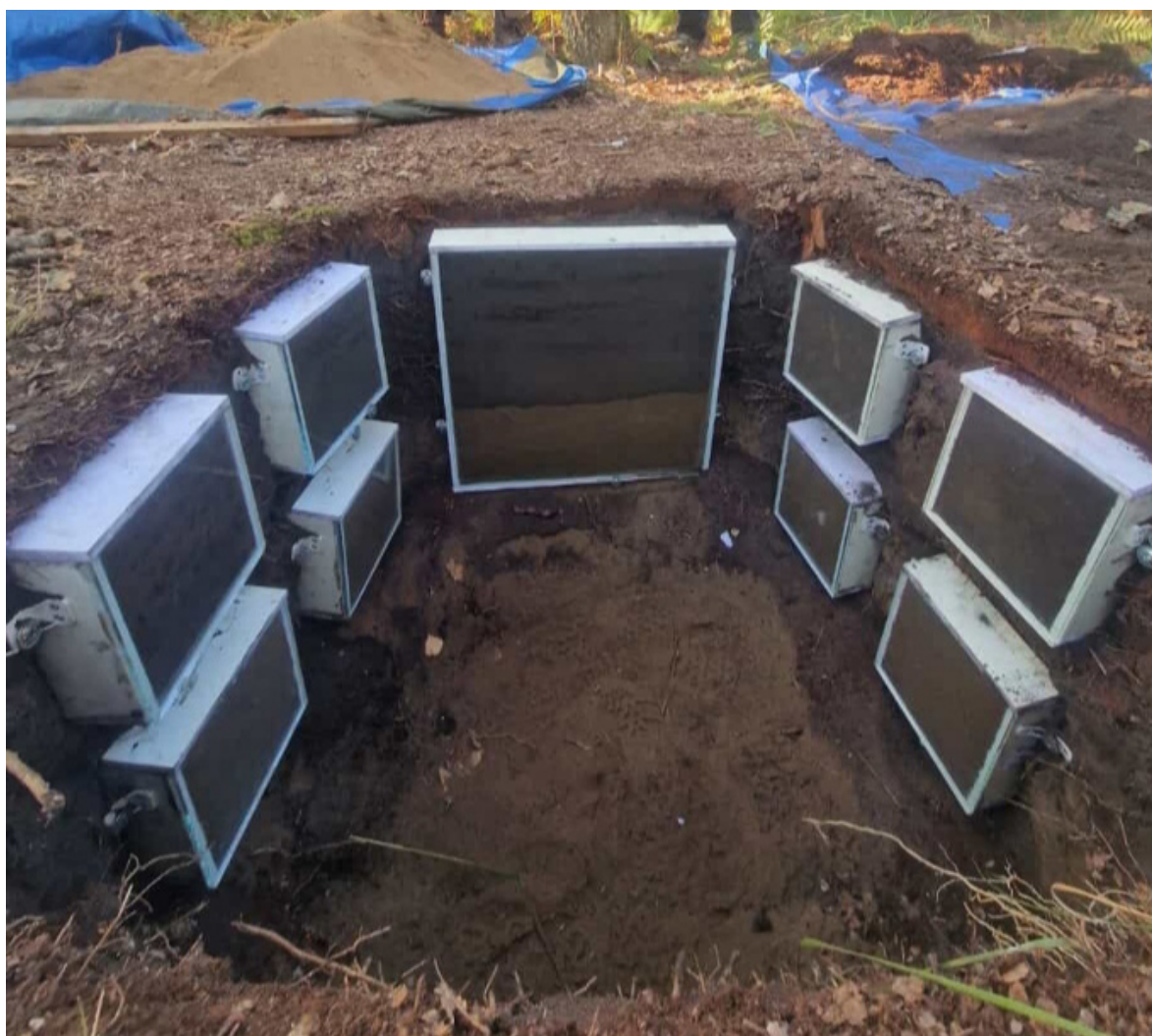
Rhizotrons mis en place dans le cadre du living Lab des forêts de pin maritime ( Pinus pinaster ) à Bordeaux en octobre 2023. © Jean-Luc Maeght
